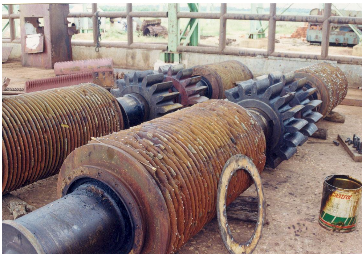
Figura 34: Cilindro de moagem passando por manutenção
