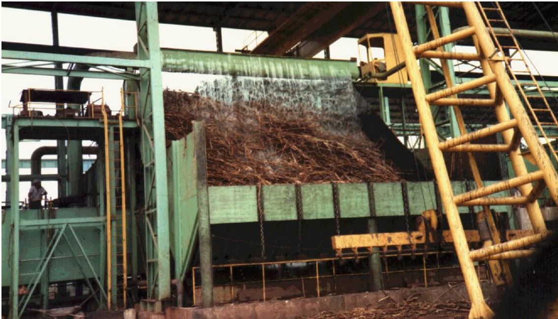
Foto 10 – A cana, recebida no galpão, é lavada antes de ser conduzida para a moagem.
